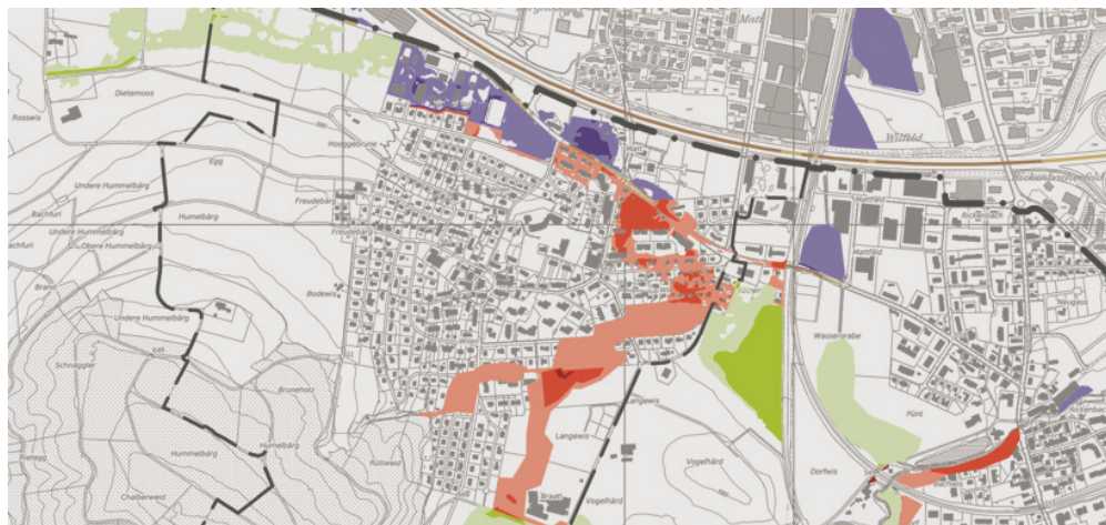
Überflutungsflächen vor Massnahmen (H/Q100). Bild: Schälllibaum AG
